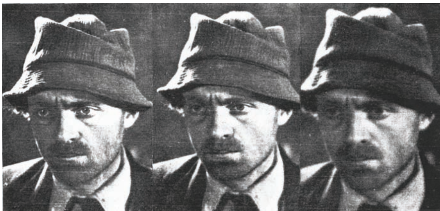
Портреты, снятые (слева направо) обычным объективом, с малярной линзой, изготовленной оператором А. Москвиным и с «малярной линзой Герца»
