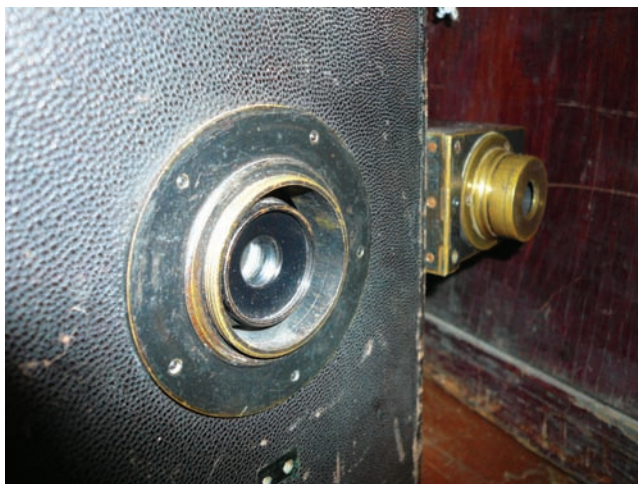
Один из первых киноаппаратов «Патэ» с объективом, изготовленным в единственном экземпляре в мастерской. У него еще нет фирменной маркировки, но уже есть визир
